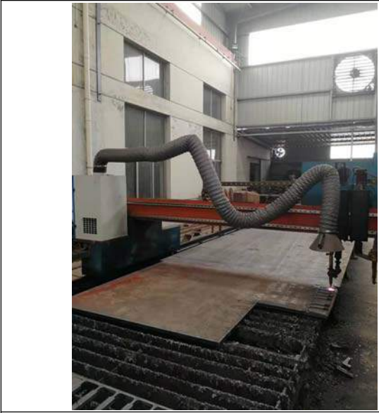
切割烟尘、焊接烟尘经烟尘净化器处理后车间内无组织排放
