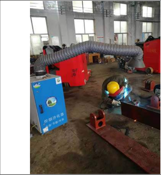
切割烟尘、焊接烟尘经烟尘净化器处理后车间内无组织排放
